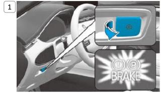
1. Unterlegkeile unterlegen und Schalter herausziehen, um Feststellbremse zu betätigen.
