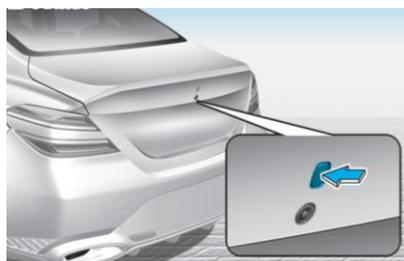
1. Pour ouvrir le coffre électrique, appuyez sur le bouton d'ouverture du coffre situé sur l'extérieur de celui-ci tout en étant muni de la clé intelligente.
