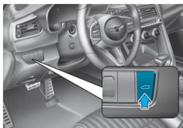
1. Pour ouvrir le coffre électrique, maintenez enfoncé le bouton d'ouverture du coffre situé sur le tableau de bord.
