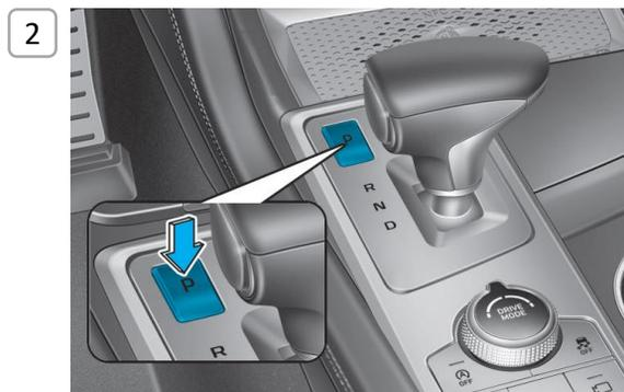
2. Sur les véhicules à transmission automatique, engagez le mode P (Stationnement).
