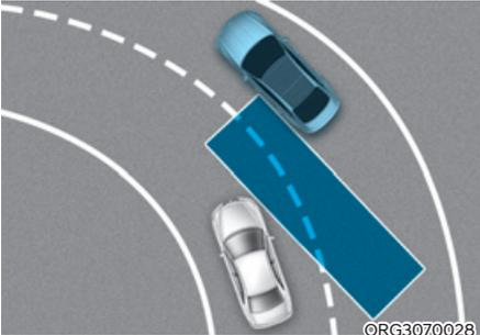
Le système de sécurité d'angle mort peut ne pas fonctionner correctement lorsque vous conduisez sur une route sinueuse. La fonction peut ne pas détecter le véhicule dans la voie adjacente.
