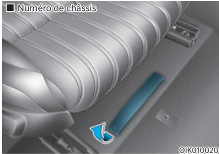
Le numéro d'identification du véhicule (VIN) est le numéro utilisé pour immatriculer votre véhicule et pour toutes les démarches légales associées à sa propriété, etc.
