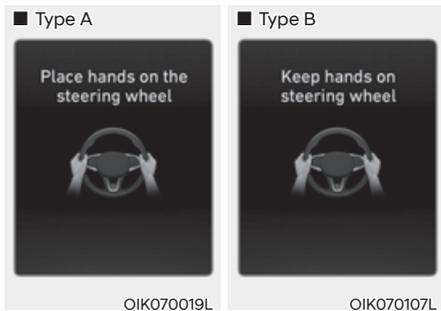
Si le conducteur retire ses mains du volant pendant plusieurs secondes, le message 'Place hands on steering wheel (Gardez les mains sur le volant)' (ou 'Keep hands steering wheel (Gardez les mains sur le volant)') apparaîtra et un signal sonore retentira par phases.
