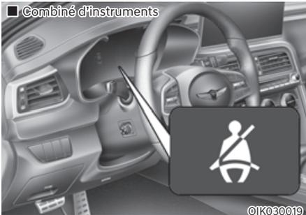
Le témoin de la ceinture de sécurité sert de rappel au conducteur : il s'allume pendant environ 6 secondes à chaque fois que le bouton de démarrage/d'arrêt du moteur est mis en position ON, que la ceinture soit attachée ou non.
