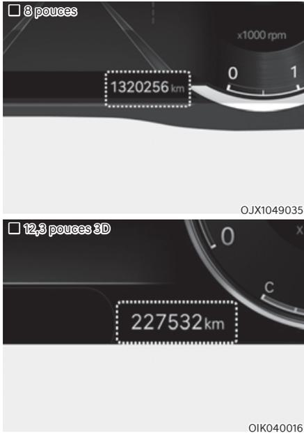
Le compteur kilométrique indique la distance totale parcourue par le véhicule et doit être utilisé pour déterminer à quel moment la maintenance périodique doit être effectuée.
