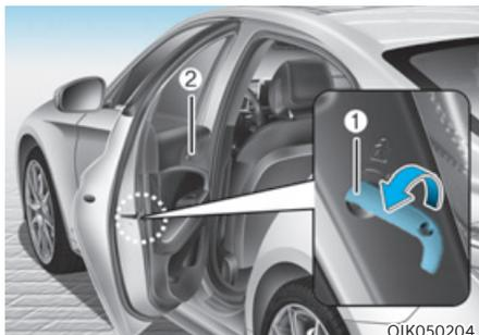
Les verrous de sécurité enfants permettent d'empêcher les enfants assis à l'arrière d'ouvrir accidentellement les portes arrière. Le verrou de sécurité des portes arrière doit toujours être utilisé lorsque des enfants sont dans le véhicule.
