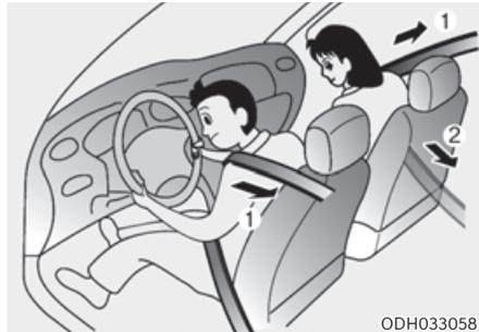
Les sièges conducteur et passager avant de votre véhicule sont équipés de ceintures de sécurité à prétension (prétensionneur avec rétracteur et dispositif de retenue d'urgence). Le prétensionneur permet de s'assurer que la ceinture de sécurité est bien plaquée contre l'occupant lors de certaines collisions frontales ou latérales. Le dispositif de retenue d'urgence peut s'activer en même temps que les airbags selon la gravité d'une collision frontale ou latérale.
