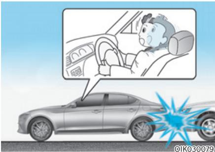
Les airbags frontaux ne sont pas conçus pour se déployer dans les collisions par l'arrière car les occupants sont projetés vers l'arrière par la force de l'impact. Dans ce cas, les airbags déployés n'offriraient aucun avantage supplémentaire.
