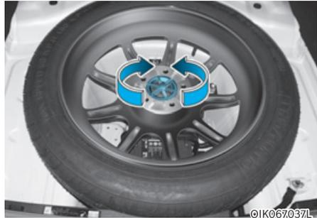
Tournez le boulon de maintien à ailettes dans le sens antihoraire pour dégager la roue de secours.
