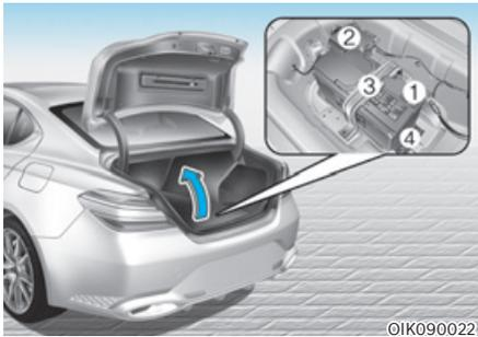
Lors du remplacement de la batterie, débranchez le câble négatif (-) (1) et retirez le boîtier de fusibles (2) de la borne positive (+) de la batterie. Retirez le panneau du coffre et la roue de secours. Posez la roue de secours au sol avec le côté jante vers le haut afin de ne pas l'endommager.
