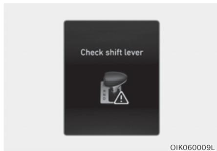
Ce message s'affiche sur l'écran LCD en cas de dysfonctionnement d'un composant essentiel de la transmission.
