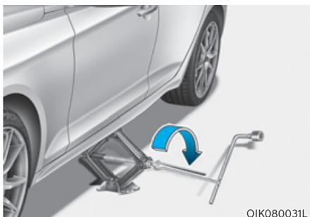
8. Introduisez la manivelle dans le cric et tournez-la dans le sens horaire jusqu'à ce que la roue ne touche plus le sol. Vérifiez que le véhicule est stable sur le cric.
