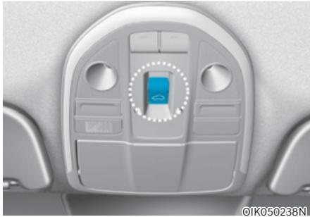
Le toit ouvrant peut être actionné uniquement lorsque le bouton de démarrage/d'arrêt du moteur est en position ON ou START.
