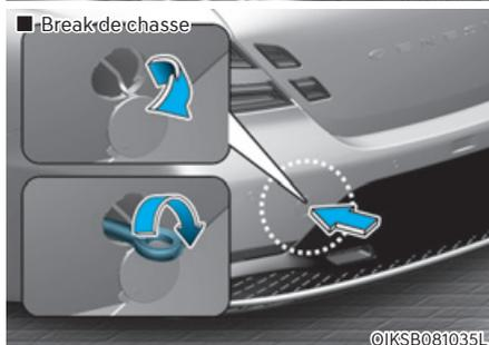
2. Retirez le cache de l'orifice en appuyant sur la partie basse du cache sur le pare-chocs.
