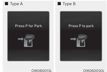
Ce message s'affiche sur l'écran LCD pour indiquer au conducteur d'appuyer sur le bouton P (Parking) lorsqu'il déplace le levier de vitesses vers le haut, même lorsque celui-ci est en position R.
