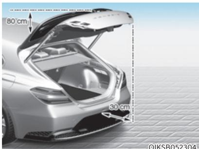
Avant d'utiliser le hayon électrique ou le hayon intelligent, vérifiez qu'aucun obstacle (personne ou objet) ne se trouve sur sa trajectoire. Tout contact avec le hayon peut entraîner des blessures graves ou endommager le véhicule ainsi que les objets environnants (mur, plafond, véhicule, etc.).
