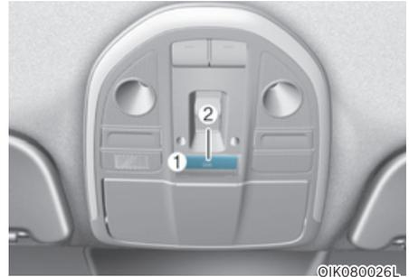
Composantes du système eCall paneuropéen installé dans l'habitacle :
