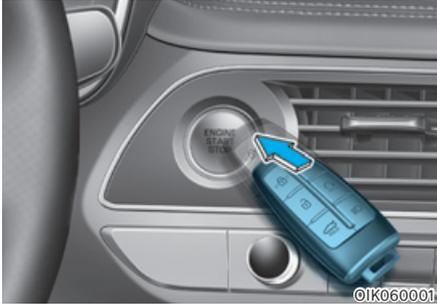
Si la pile de la clé intelligente est usée ou si la clé intelligente ne fonctionne pas correctement, vous pouvez démarrer le moteur en appuyant sur le bouton de démarrage/d'arrêt en plaçant la clé intelligente comme illustré ci-dessus.
