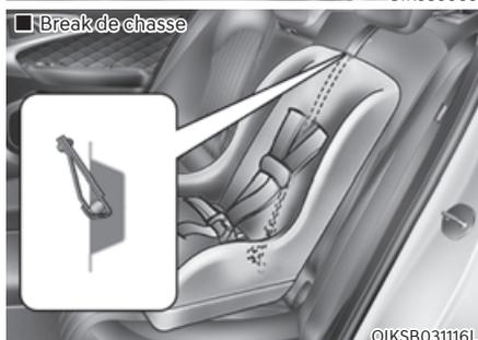
1. Faites passer la sangle d'ancrage supérieur du système de retenue pour enfants par dessus le dossier. Pour placer la sangle de fixation supérieure, suivez les instructions du fabricant du système de retenue pour enfants.
