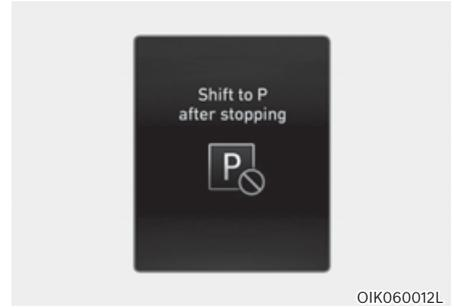
Ce message s'affiche sur l'écran LCD lorsque vous essayez de passer en position P (Parking) alors que le véhicule est en mouvement. Arrêtez le véhicule avant de positionner le levier de vitesses sur P (Parking).
