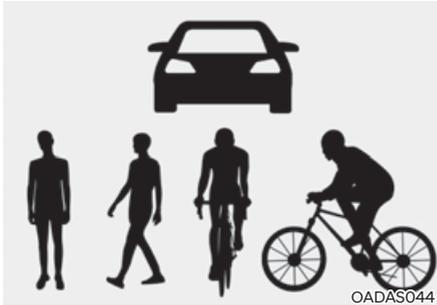
L'illustration ci-dessus montre l'image que la caméra et le radar avant sont capables de détecter comme étant un véhicule, un piéton et un cycliste.
