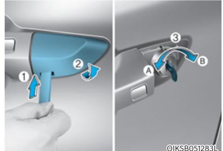
Pour verrouiller les portes avec la clé mécanique, retirez le cache et tournez la clé.
