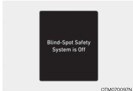
Lorsque le moteur est redémarré avec le système désactivé, le message « Blind-Spot Safety System is Off » (Syst. d'assistance angles morts désactivé) apparaît dans le combiné d'instruments.
