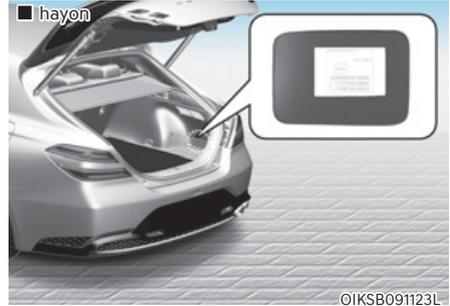
A l'intérieur du couvercle du boîtier de fusibles/relais, vous trouverez l'étiquette du fusible/relais décrivant les noms des fusibles/relais et leur calibre.
