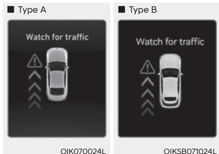
Avertissement de collision lorsque l'on sort du véhicule
