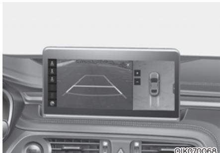
Le moniteur de vue panoramique aidera au stationnement à l'aide des caméras installées sur le véhicule et affiche des images autour du véhicule via l'écran du système d'infodivertissement.
