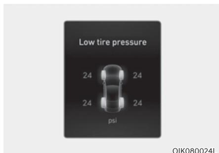
Ce message d'avertissement s'affiche si la pression des pneus est basse. Le pneu correspondant sur le véhicule s'allume.
