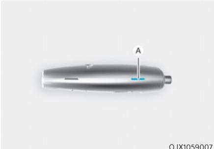
1. Placez un chiffon doux sur la rainure (A) et à l'aide d'un tournevis à tête plate, ouvrez le couvercle de la clé intelligente.
