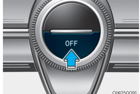
Appuyez sur le bouton OFF pour désactiver la climatisation. Cependant, vous pouvez toujours actionner les boutons de mode et d'admission d'air tant que le bouton de démarrage/d'arrêt du moteur est en position ON.
