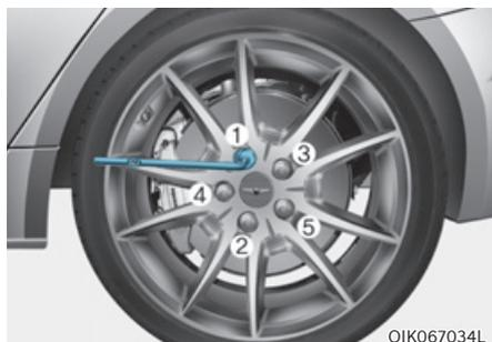
6. Desserrez les écrous de roue d'un tour dans le sens antihoraire en suivant l'ordre indiqué ci-dessus, mais ne les retirez pas tant que le pneu n'est pas surélevé.
