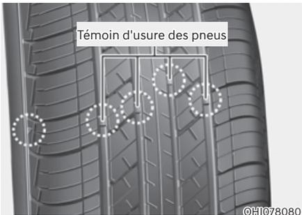
Si le pneu est utilisé uniformément, un indicateur d'usure de la bande de roulement apparaîtra sous la forme d'une bande pleine sur la bande de roulement. Cela indique qu'il reste moins de 1,6 mm (1/16 po) de bande de roulement sur le pneu. Remplacer le pneu lorsque cela se produit.
