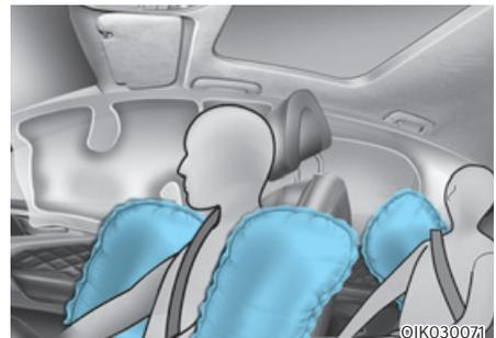
Votre véhicule est équipé d'un airbag latéral pour chaque siège avant et les sièges extérieurs de la deuxième rangée de sièges. De plus, un airbag avant central est prévu du côté intérieur du dossier du conducteur. Le but de l'airbag est d'offrir une protection supplémentaire du véhicule par rapport à celle offerte par la seule ceinture de sécurité.
