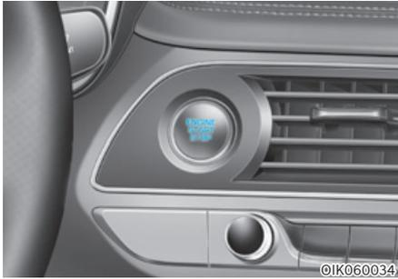
Lorsque la porte avant est ouverte, le bouton de démarrage/arrêt du moteur s'éclaire et s'éteint 30 secondes après la fermeture de la porte.
