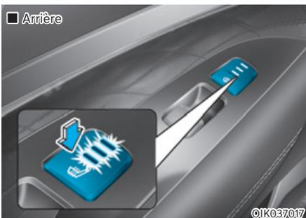
Lorsque le moteur tourne, appuyez sur l'un des commutateurs pour chauffer le siège conducteur ou passager avant (et/ou le siège passager arrière).
