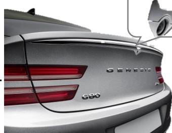
1. Pour ouvrir le coffre électrique, appuyez sur le bouton d'ouverture du coffre situé sur l'extérieur de celui-ci tout en étant muni de la clé intelligente.
