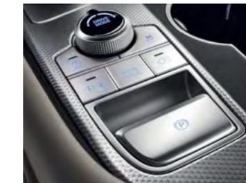
Электронный стояночный тормоз (EPB, с режимом автоматического удержания)
