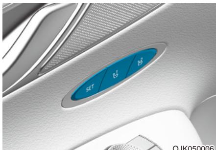
Система встроенной памяти для водительского сиденья предназначена для хранения и выбора следующих настроек памяти при помощи простой кнопки.
