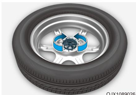
Для снятия запасного колеса открутите барабашковый болт против часовой стрелки. Храните запасное колесо в том же отделении, затянув барабашковый болт по часовой стрелке. Для предотвращения возникновения дребезжащего звука от запасного колеса и инструментов храните их в соответствующих местах.
