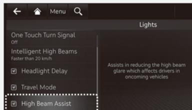
Когда кнопка «ENGINE START/STOP» (запуска/остановки двигателя) находится в положении «ON» (Вкл.), выберите «Lights» (Освещение) → «High Beam Assist» (Система автоматического переключения фар дальнего света (НВА)) в меню «Settings» (Настройки), чтобы включить систему автоматического переключения фар дальнего света, и отмените выбор для отключения системы.
