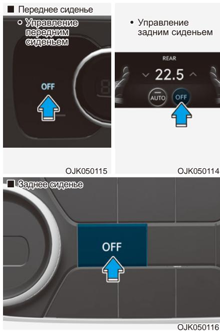
Коснитесь пиктограммы «OFF» (Выкл.) или нажмите кнопку «OFF» (Выкл.), чтобы выключить систему климат-контроля. Управлять подачей воздуха и режимами можно до тех пор, пока кнопка «Engine Start/Stop» (Запуск/остановка двигателя) находится в положении «ON» (Вкл.).
