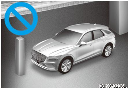
Эффективность работы интеллектуальной системы дистанционной парковки может снизиться или может произойти столкновение, если рядом с парковочным местом находится узкий столб, круглая тумба, квадратный столб или столб с окружающими его объектами (например, пожарный гидрант и т.п.). Водителю следует припарковать автомобиль самостоятельно.
