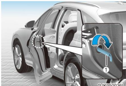
Замок для защиты детей предназначен для предотвращения случайного открытия задних дверей детьми, сидящими сзади. Их следует использовать всякий раз, когда в автомобиле находятся дети.
