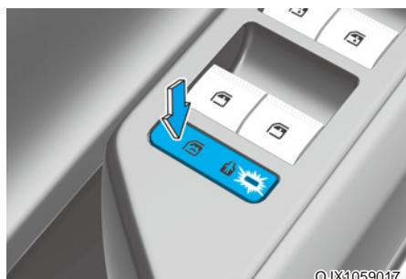
Кроме того, если будет обнаружено приближающееся сзади транспортное средство, когда устройство блокировки замка для защиты детей находится в положении «LOCK» (Блокировка), блокировка замка для защиты детей не будет снята для предотвращения открытия задних дверей, даже если водитель нажмет кнопку разблокирования.
