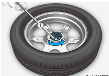
Если сложно вывернуть барабашковый болт колеса вручную, это можно легко сделать с помощью баллонного ключа (1). Открутите барабашковый болт колеса против часовой стрелки с помощью баллонного ключа.
