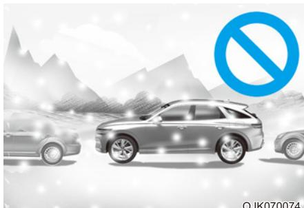
Снег может помешать работе датчиков в процессе парковки, а на скользкой дороге может быть отменена работа интеллектуальной системы дистанционной парковки.
