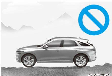
Работа интеллектуальной системы дистанционной парковки может быть отменена, если автомобиль пробуксовывает или не может продолжать движение из-за состояния дорожного покрытия, например на гравийном или бульжном участке.
