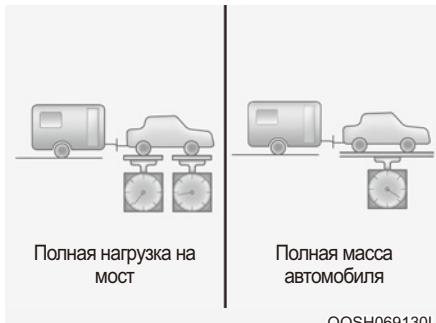
Нагрузка на тягово-сцепное устройство является важным параметром, который необходимо знать, поскольку он влияет на общую максимальную массу (GVW) автомобиля. Нагрузка на тягово-сцепное устройство не должна превышать 10 % от полной массы прицепа и находиться в пределах максимальной допустимой нагрузки на тягово-сцепное устройство.
