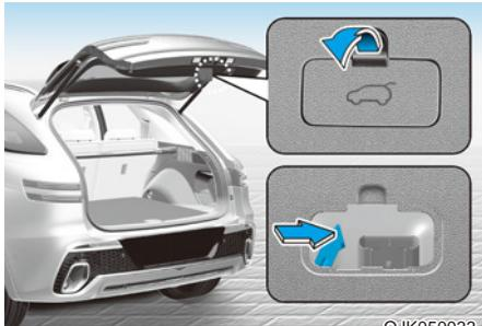
Чтобы разблокировать и открыть вручную дверь багажника со стороны багажного отделения, необходимо выполнить следующие действия:
