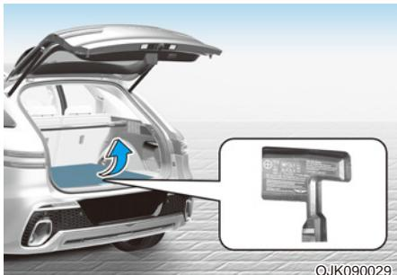
С внутренней стороны крышки блока реле и предохранителей находится этикетка с указанием названий предохранителей/реле и их номинальных характеристик.
