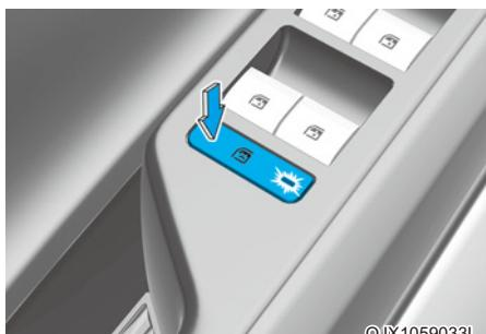
Водитель может заблокировать переключатели электростеклоподъемников задних дверей с помощью кнопки блокировки электростеклоподъемников.
