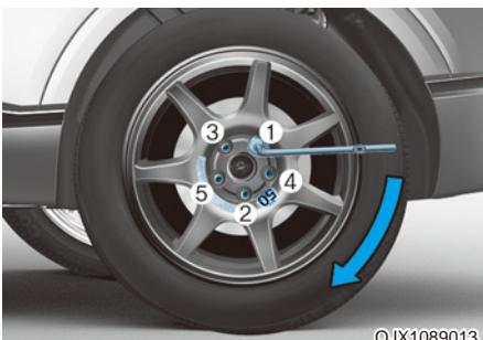
16. Затяните гайки с помощью балонного ключа в указанном порядке. Выполните повторный контроль затяжки каждой гайки. После замены колеса рекомендуется как можно скорее обратиться к официальному дилеру продукции марки Genesis для затяжки болтов крепления колеса с надлежащим крутящим моментом. **Момент затяжки болта крепления колеса — 14~16 кгс/м.**
