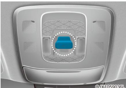
Люк в крыше может быть открыт, закрыт или наклонен, только когда кнопка «Engine Start/Stop» (Запуск/остановка двигателя) находится в положении «ON» (Вкл.).
