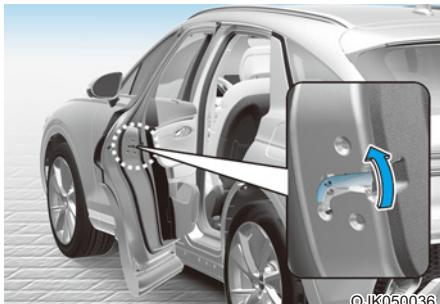
В непредвиденной ситуации, например если разряжена аккумуляторная батарея, единственным способом блокирования двери(ей) является использование механического ключа снаружи.
